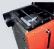
Sistema de limpieza exterior del intercambiador
