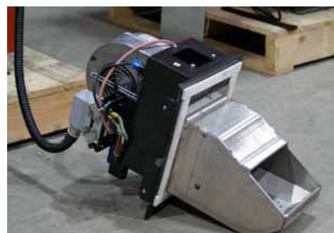
Quemador de aire insuflado con rendimiento de combustión del 92% (Certificado I.G. nº 213712 del 14/07/2006)
